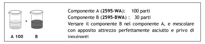
Miscelare meccanicamente con trapano a frusta, prima il componente A da solo. Aggiungere il componente B e continuare la miscelazione fino ad ottenere un composto assolutamente omogeneo. Particolare attenzione deve essere posta nella fase di miscelazione sul fondo del secchio, in quanto il prodotto mal miscelato potrebbe causare seri problemi di essiccazione.
